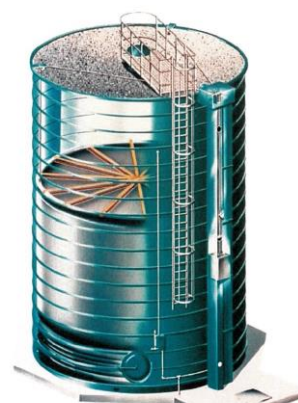
Figure 37 : Gazomètre souple protégé d'une virole métallique
