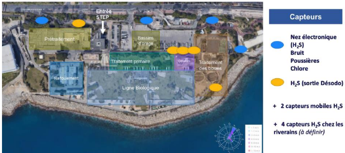
Figure 102 : Emplacement des mesures odeurs sur le site
