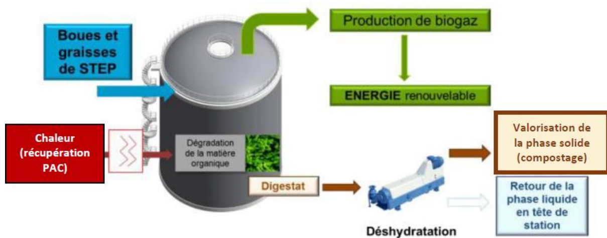
Figure 18 : Principe de la méthanisation
