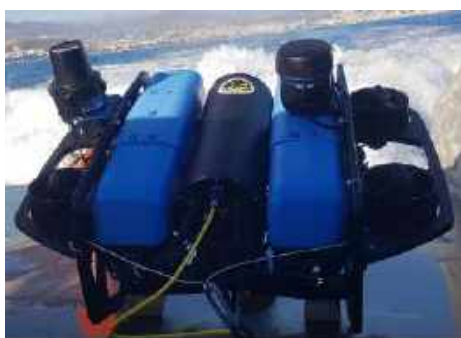
ROV avec sonar et système de positionnement
