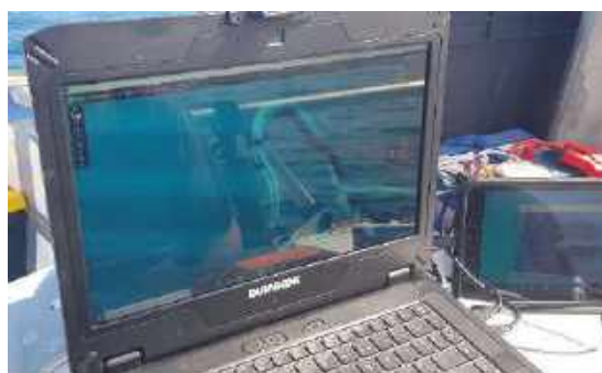
Station de contrôle surface (écrans de retour surface : à gauche vidéo, à droite sonar)
