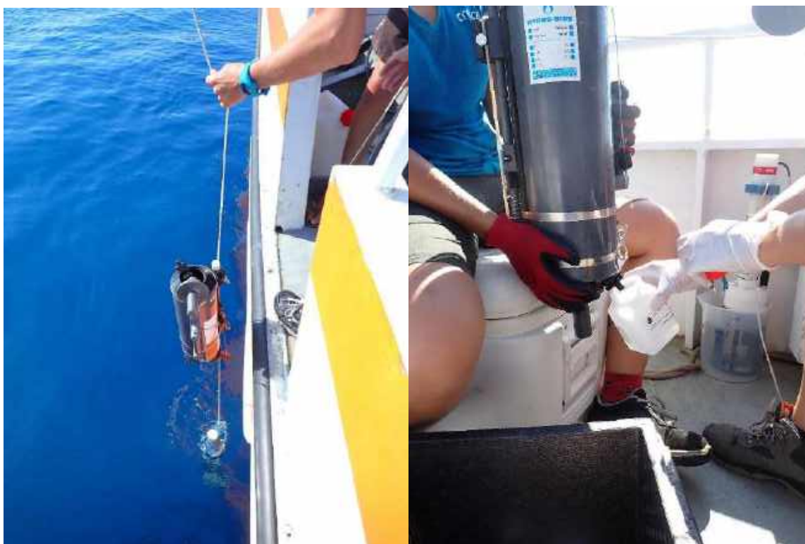
Figure 4 : Illustration du montage de la bouteille NISKIN au-dessus de la sonde RBR (à gauche) et remplissage des flacons (à droite)
