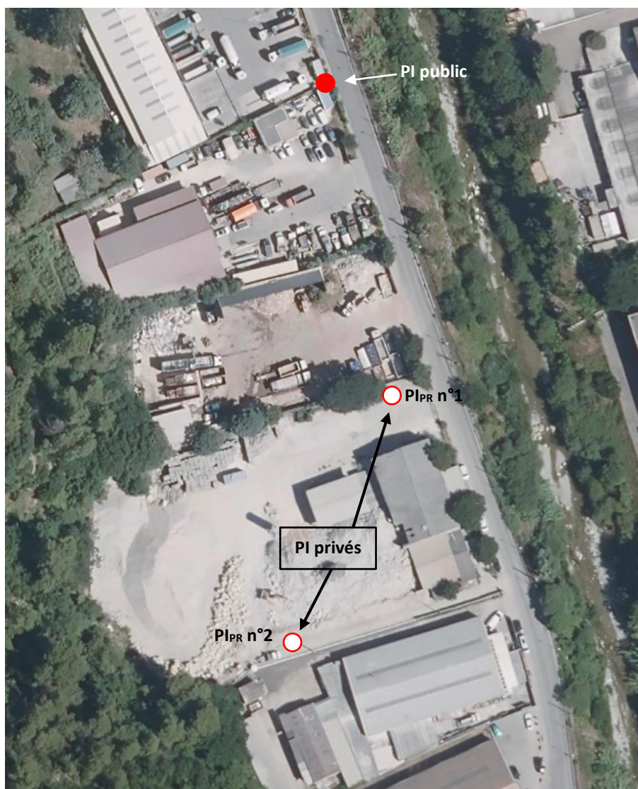
Figure 12 : Implantation des poteaux incendie
