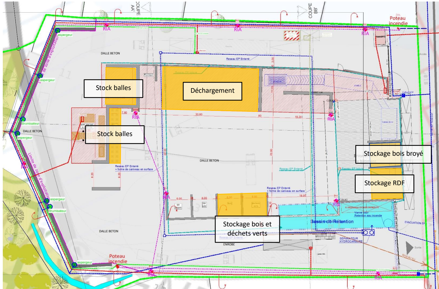
Figure 9 : Implantation des stocks de déchets combustibles
